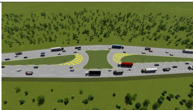
รูปที่ 8-2 รูปแบบจุดกลับรถระดับดินสำหรับรถใหญ่
